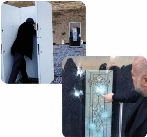
9 mm çaplı silah ile 10 adet mermi atılarak yapılan teste gerek metal gerek ise camlı kısım herhangi bir mermi çıkıştı gerçekleşmemiş, Sur ÇELİK KAPı'nın kurşun geçirmezlik özelliğine hizmetinde yapılan bu test ile doğrulanmıştır.
